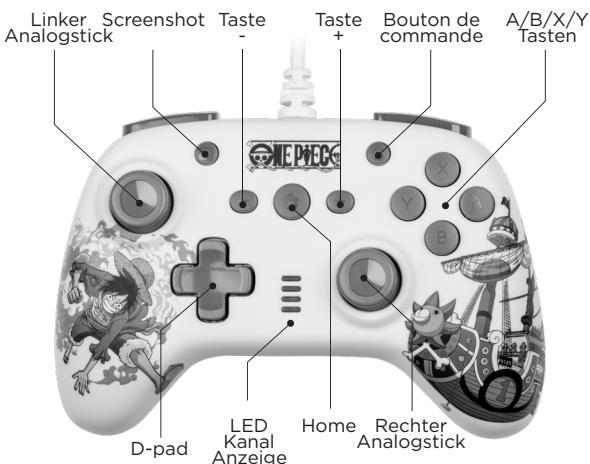
**Hinweis:** Ein vertikales Drücken des linken Analogsticks ist L3; ein vertikales Drücken des rechten Analogsticks ist R3; Kanalanzeigen sind LED1, LED2, LED3, LED4 von oben nach unten.
