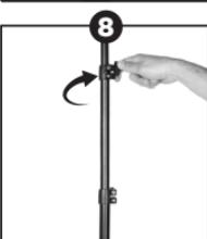
Ziehen Sie die Schrauben an, um das Stativ zu fixieren.
