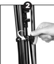
Desserrez le bouton de la vis de fixation.
