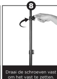
Draai de schroeven vast om het vast te zetten.
