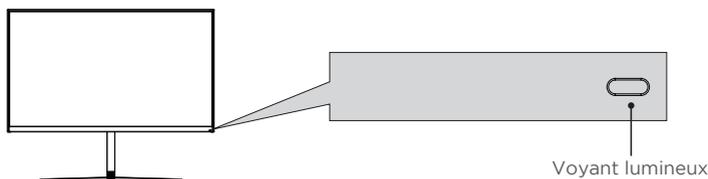
Le voyant bleu fixe indique que l'appareil est sous tension et que le moniteur fonctionne normalement. Le voyant bleu clignotant indique qu'aucune source vidéo n'a été détectée. Le voyant rouge indique qu'aucun signal horizontal ou vertical n'a été détecté ou que la tension est faible. Veuillez vous assurer que votre ordinateur est allumé et que tous les câbles vidéo sont complètement insérés et/ou connectés.
