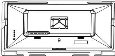
3. Retirez la tige et la base, verrouillez-les avec 2 vis KM4 \* 12 mm. (Les vis sont dans le sachet d'accessoires, tampon 1 pièce)
