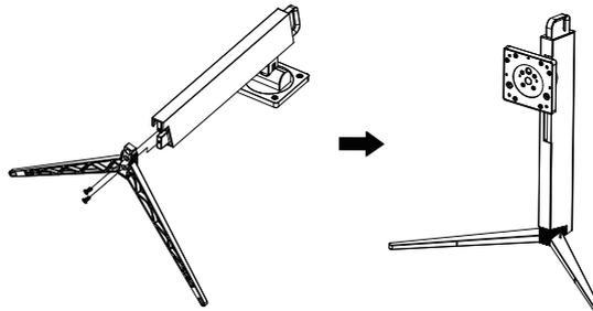
4. Insérez la tige dans la fente du couvercle arrière, et verrouillez-le avec 4 vis CM4 \* 26 mm. (Les vis sont dans le sachet d'accessoires).
