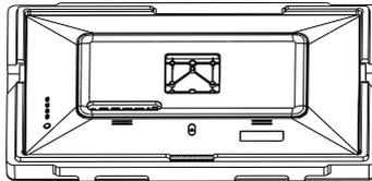
3. Sortez 4 connecteurs VESA (hauteur 30 mm, dans le sachet d'accessoires) et utilisez-les pour verrouiller le couvercle arrière, à l'aide d'un tournevis droit.
