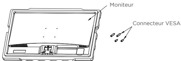
2. Verrouillez les deux connecteurs VESA 26 mm dans les deux orifices supérieurs à l'arrière du moniteur et les deux connecteurs 10 mm dans les deux orifices inférieurs.
